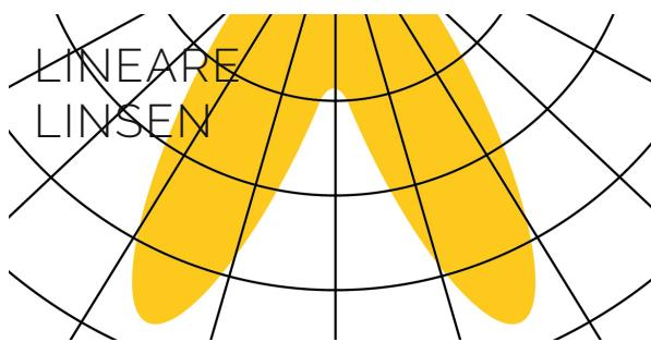
Lineare Linsenprofile werden verwendet, um spezielle Abstrahlwinkel mit höchster Effizienz zu erzeugen und gleichzeitig die Lichtquelle zu schützen.
